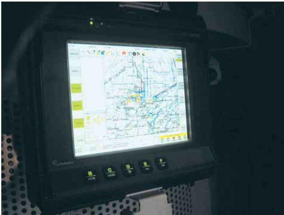
Lo schermo di back-up del sistema di comando, controllo e navigazione SICCONA installato nel vano trasporto del FRECCIA. Il display garantisce alla squadra la massima situational awareness prima dello sbarco appiedato.
