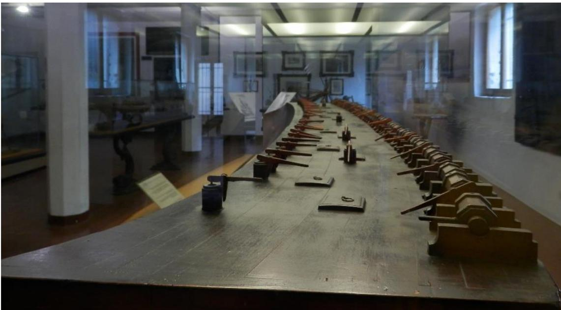
**IV.10** Particolare delle pompe idrauliche poste sulla parte superiore del *cammello*, che ne permettevano lo svuotamento dall'acqua.
